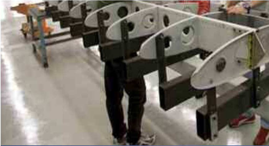
Laboratorio di costruzioni aeronautiche: scalo per l'assemblaggio della semiala GV-1
