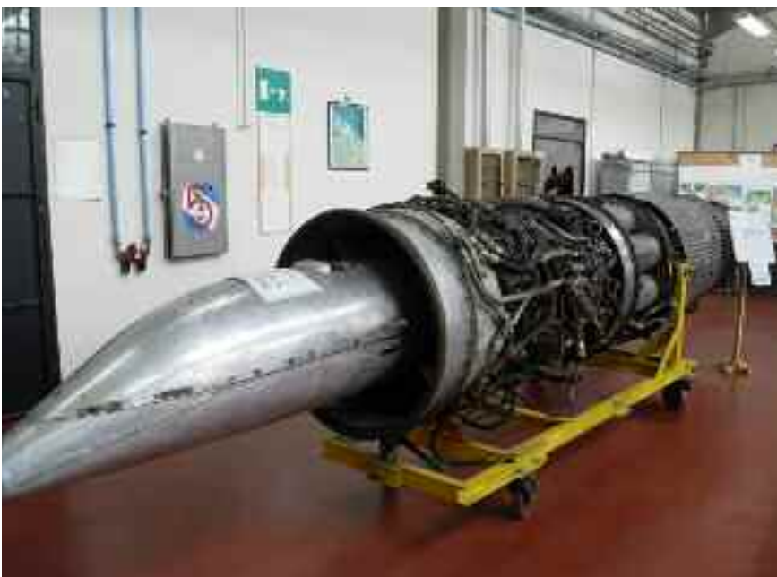
Una vista complessiva del motore GE J47-GE-17B. È uno dei pochi motori rimasti ancora completo di postbruciatore
