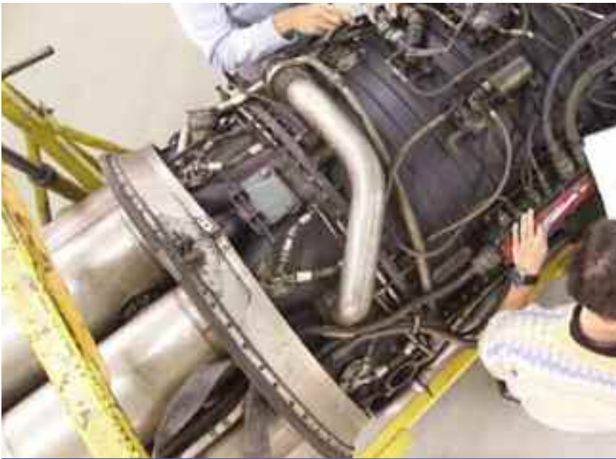
Sezione compressore e accessori del motore GE J47-GE-17B installato sul velivolo F-86K
